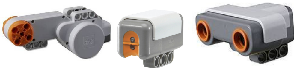
Abbildung 3.2: Lego Mindstorms Komponenten; von links nach rechts: Servo Motor, Licht Sensor und Ultraschall Sensor
