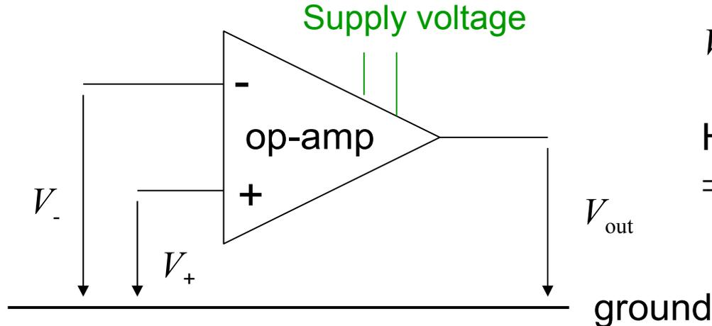
$$V_{\text{out}} = (V_+ - V_-) \cdot g$$
