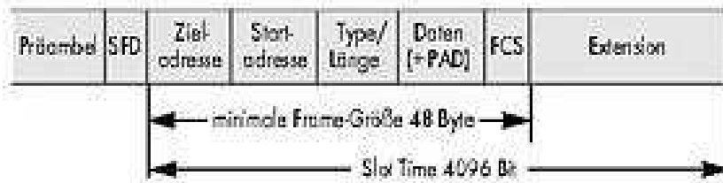
Abbildung 2.122: Paketerweiterung ( extension ) beim Gigabit-Ethernet (©c't, 1999)
