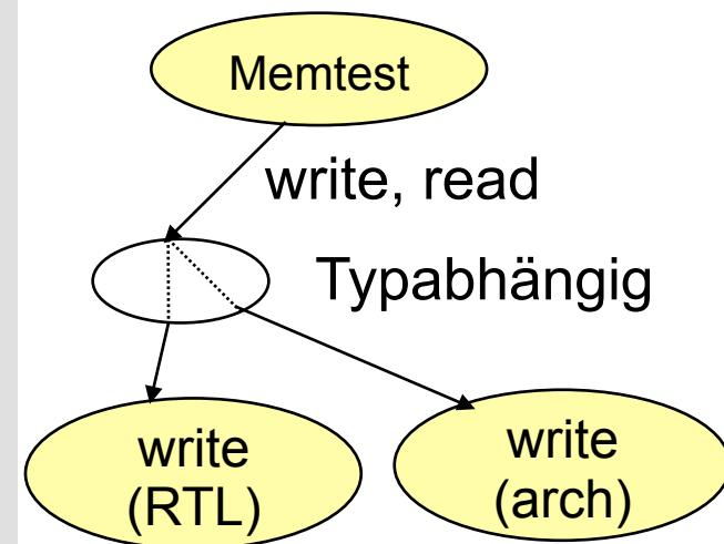
Die gleiche Speichertestmethode verwendet Modelle des Speichers mit unterschiedlicher Präzision
