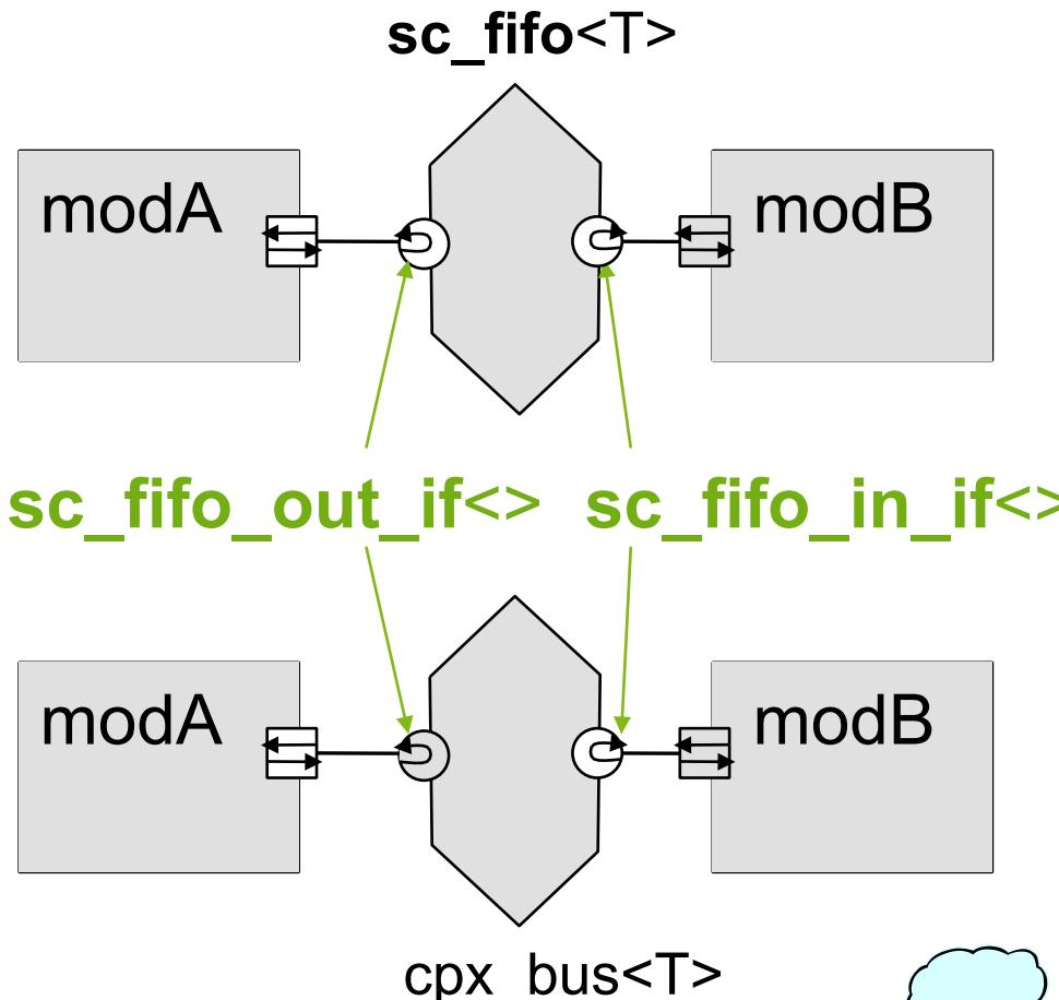
Im oberen Entwurf sind Module über eine FIFO verbunden, im unteren über einen komplexen Bus.
