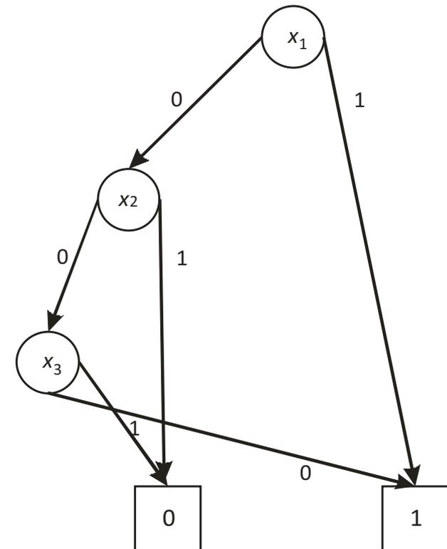
→ hier:  $f_{bsp} = \bar{x}_1 \bar{x}_2 \bar{x}_3 \vee x_1$
