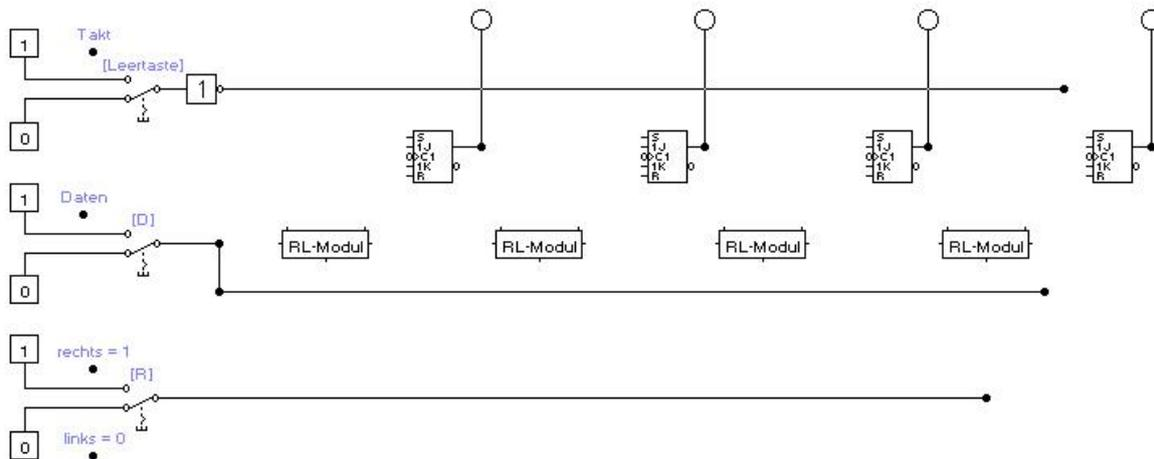
Vervollständigen Sie die Schaltung (auch das RL-Modul) zu einem 4-Bit-Rechts/Links-Schieberegister. Sie dürfen beim RL-Modul nur genau die vorgesehenen Anschlüsse benutzen. Außerhalb des Makros brauchen Sie nur Leitungen ziehen und benötigen keine weiteren Bauteile.
