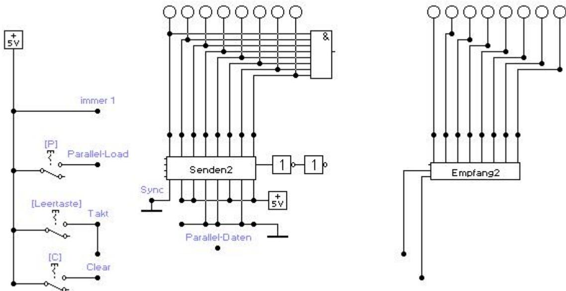
Bauen Sie die Makros „Senden2“ und „Empfang2“ zu einen Parallel-Seriell-Umsetzer aus, der nach dem im folgenden beschriebenen Prinzip arbeitet:
