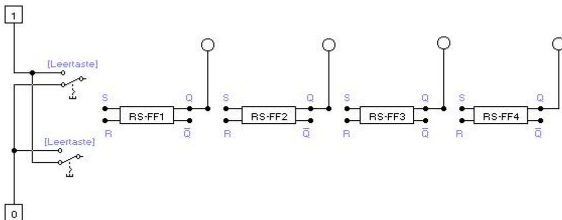
Verbinden Sie die Flipflops so, dass ein unkontrolliertes Schieberegister entsteht. Das erste Flipflop soll so an die Ansteuerschaltung angeschlossen werden, dass entweder die Eingabe 01 oder 10 möglich ist.
