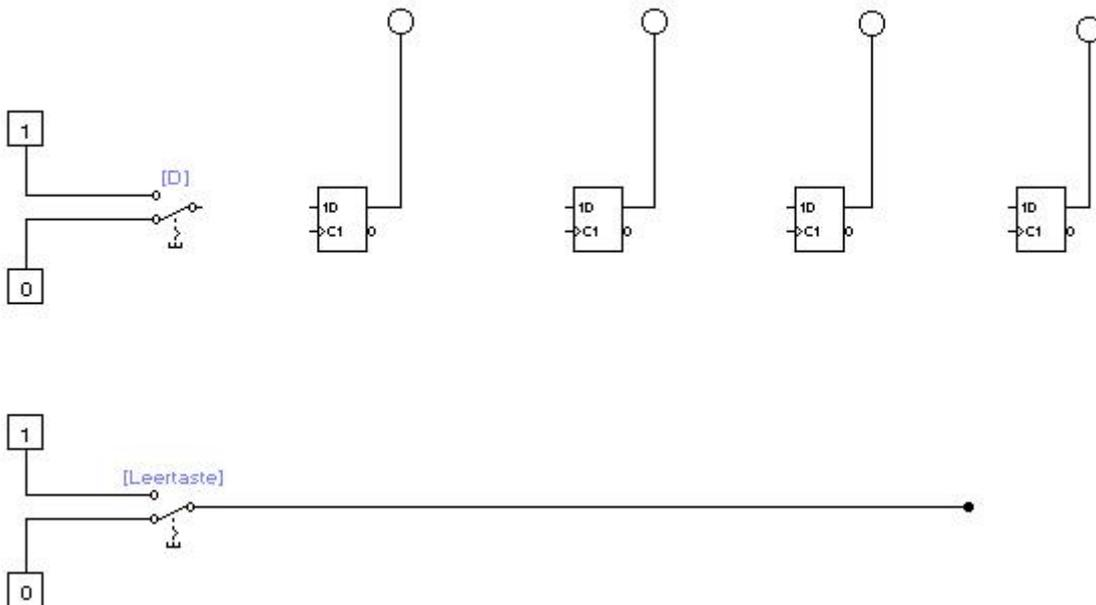
Beschalten Sie das Schieberegister so, dass die Lämpchen nach mehreren Takten von links nach rechts die Kombination 0001 und 1011 anzeigen.
