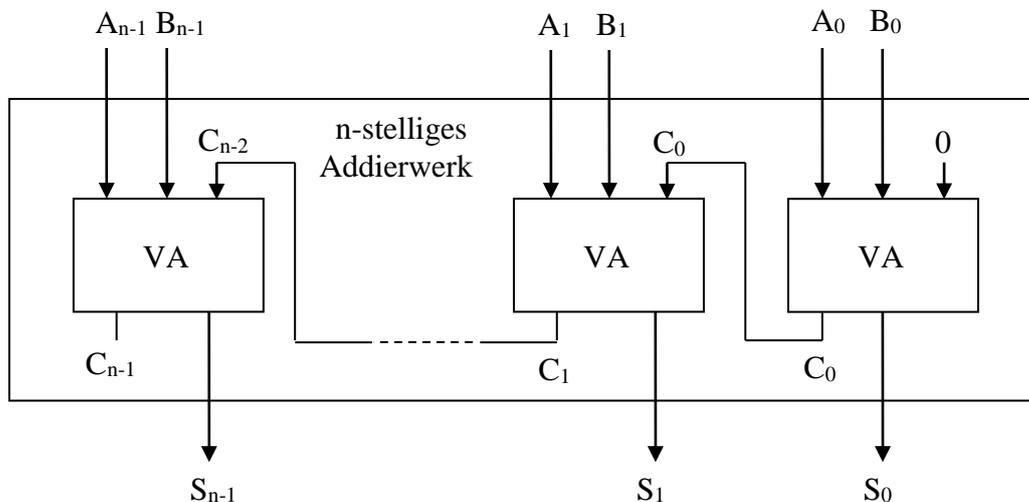
Im Addierwerk des Ripple-Carry-Adders arbeiten die Volladdierer parallel, d.h. gleichzeitig. Die von den Volladdierern berechneten Summen stehen aber nicht zur gleichen Zeit zur Verfügung, weil jeder der Volladdierer einen Übertrag von der nächstniedrigeren Stelle erhält. Die Summenwerte an den Ausgängen des Addierwerks sind erst dann gültig, wenn der Volladdierer der Stelle mit dem höchsten Gewicht ( $2^{n-1}$ ) den Übertrag  $C_{n-1}$  erhalten hat. Die Überträge entstehen also nacheinander.
