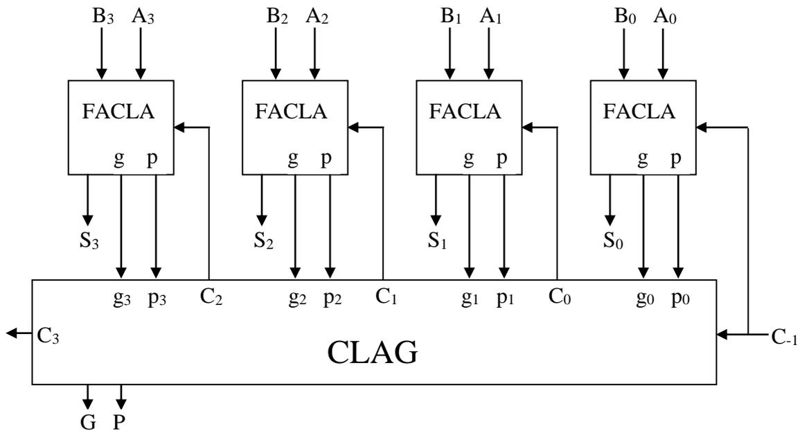
Die Blackboxes FACLA (Full-Adder-Carry-Look-Ahead) erhalten die umgebaute Volladdiererschaltung. Der CLAG (Carry-Look-Ahead-Generator) erzeugt aus den g- und p-Hilfsvariablen die Überträge  $C_n$ . Man beachte: Die in dieser Schaltung benutzten Volladdierer in den FACLAs erzeugen keine Überträge.
