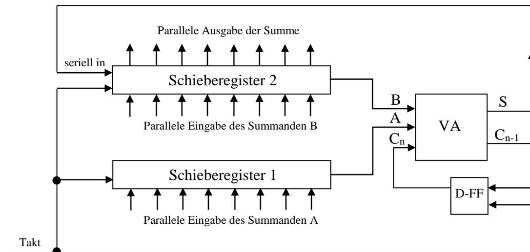
In der Datei v640 finden Sie ein mit zwei Schieberegistern „8-Bit SR“ aufgebautes serielles Addierwerk:
