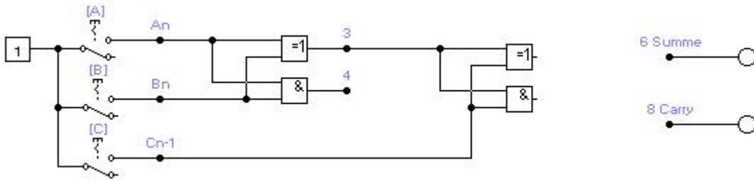
Ergänzen Sie die Schaltung mit Hilfe der beiden Gleichungen (6) und (8) so, dass ein Volladdierer entsteht.
