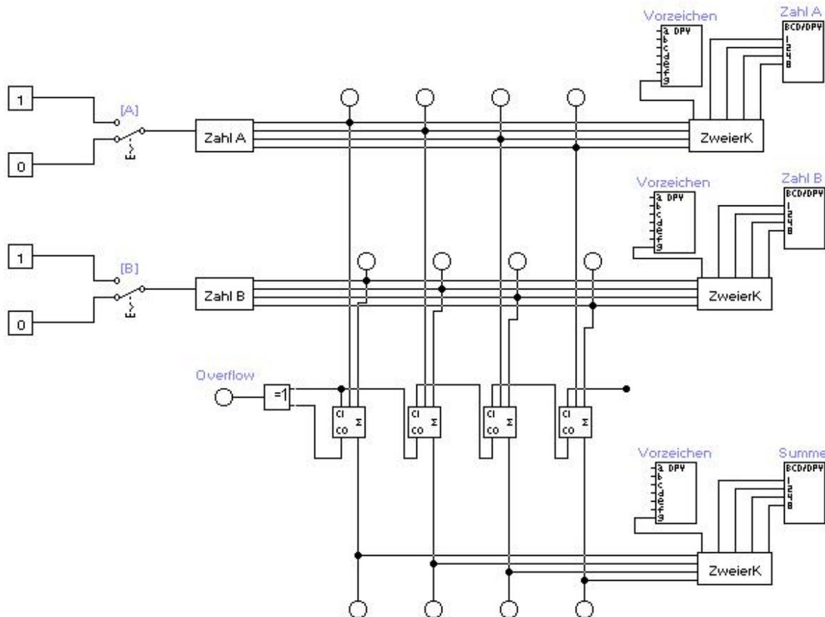
Die obige Schaltung befindet sich in der Datei v610 und enthält ein Addierwerk des Typs Ripple-Carry-Adder. Verwendet werden vorgefertigte Volladdierer aus der Bauelementebibliothek des EWB. Der Carry-In Eingang des rechten Volladdierers bleibt unbeschaltet und liegt somit auf 0.
