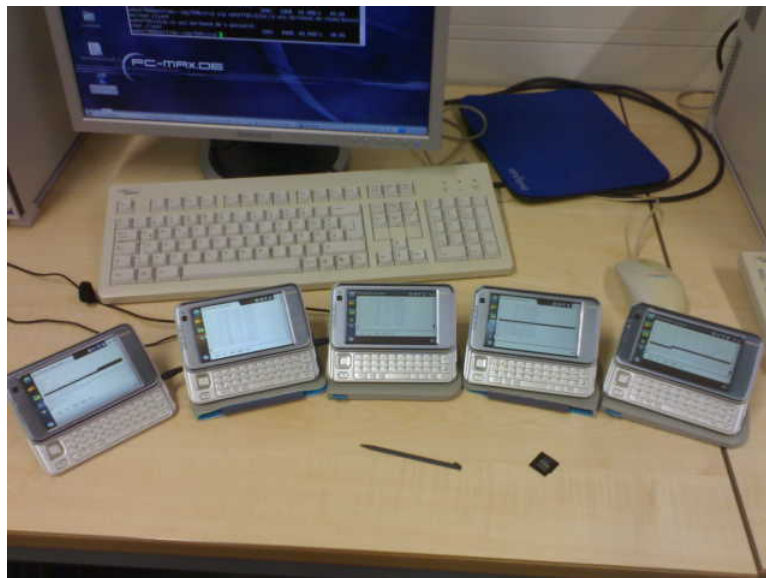
Abbildung 4.8: Aufbau des Multihoptests mit fünf Geräten
